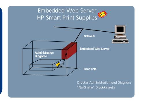
Mit einem Embedded Webserver bekommen Sie Informationen über den Zustand Ihres Druckers so einfach wie noch nie. Basis dafür ist eine im Gerät integrierte Homepage, die Informationen wie Füllstand der Kartusche, Anzahl der gedruckten Seite oder Warn- und Störungsmeldungen zur Verfügung stellt. Sie werden automatisch per E-mail oder SMS informiert.
